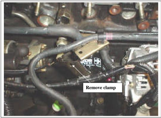
37) Loosen the alternator 14mm pivot bolt.
